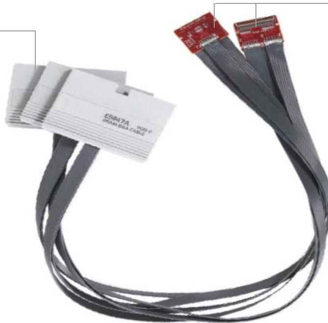
Figure 7 E5847A Single-ended ZIF probe cable
